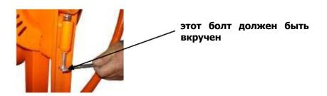
13. Смонтируйте кожух мотора на штифт, на котором находиться колесо
